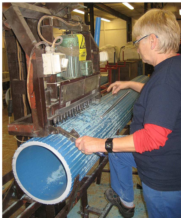
Budafilter specialitás: a tekercselt szűrő gyártási lépései
